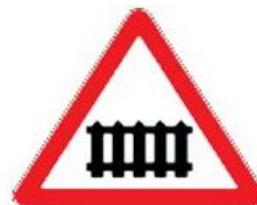
Железнодорожный переезд со шлагбаумом
